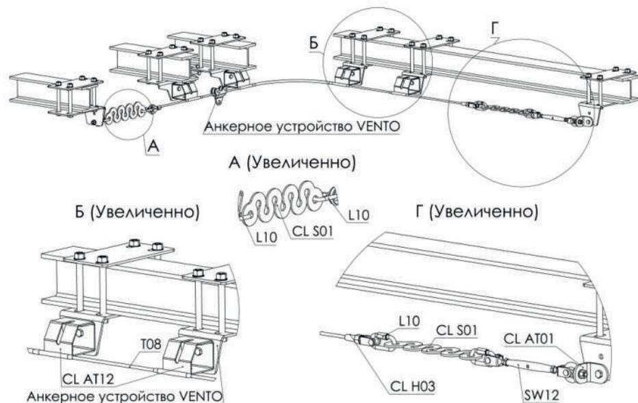
Монтаж системы на несущую конструкцию осуществляется с помощью набора структурных анкеров и/или анкерных пост-столбиков.
