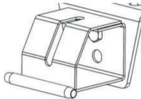
На амортизатор рывка, с помощью карабина L10 смонтировать трос с предустановленным заводским способом коушем T08 и пропустить трос через направляющие промежуточных структурных анкеров.
