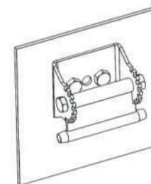
**Внимание!** Минимальная разрушающая нагрузка на гибкую анкерную линию анкерной системы 33,3 кН.
